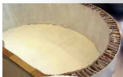
LAMES DE CARTON COLLÉES ENTRE DEUX SURFACES
